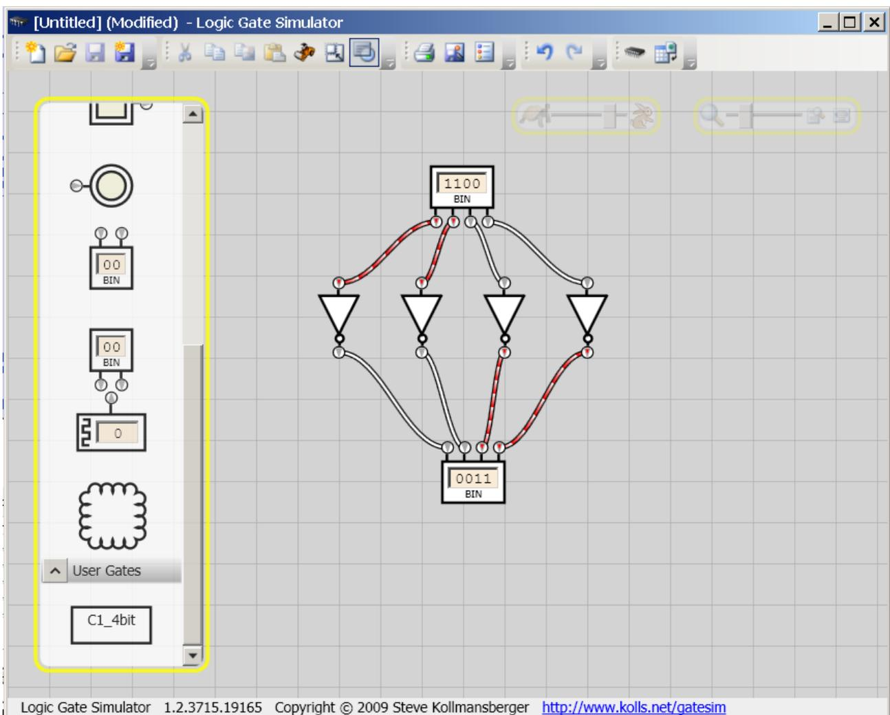
La soluzione proposta può essere salvata in GATESIM (Create IC), ma porta ad un circuito senza input ne output... Meglio utilizzare gli input/output singoli per salvare un circuito riutilizzabile.
