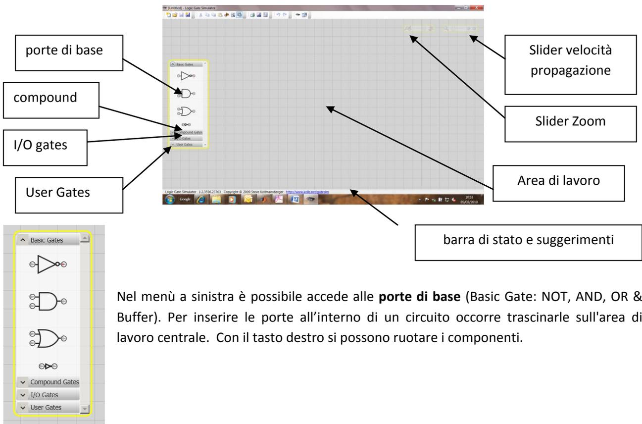
Nel menù a sinistra è possibile accedere alle **porte di base** (Basic Gate: NOT, AND, OR & Buffer). Per inserire le porte all'interno di un circuito occorre trascinarle sull'area di lavoro centrale. Con il tasto destro si possono ruotare i componenti.
