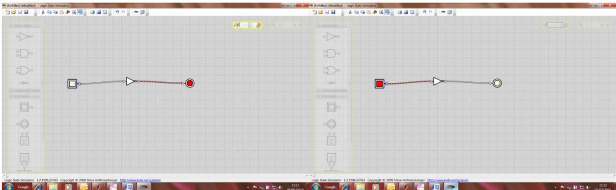
Dal menù a sinistra trascinare una porta di input, una porta NOT ed un indicatore di output nell'area di lavoro. Eseguire i collegamenti come da schema. Cliccando il tasto destro sulla porta di input è possibile impostare il nome. Cliccando sulla porta di input, il segnale viene messo a true/false e dopo un certo delay l'uscita si modifica di conseguenza. La velocità di propagazione del segnale può essere controllata con l'apposito slider.
